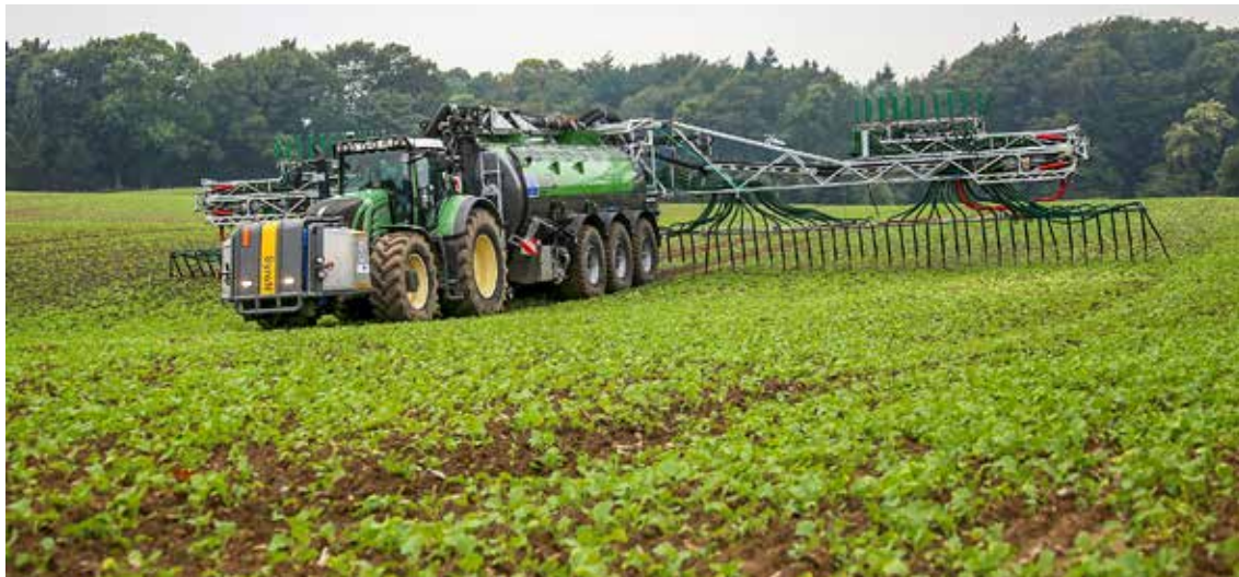
Ansäuerung von Gülle mit Schwefelsäure unmittelbar bei der Applikation. Im Vergleich zur Schleppschlauchausbringung ohne Ansäuerung können Ammoniakverluste nochmals reduziert werden.
