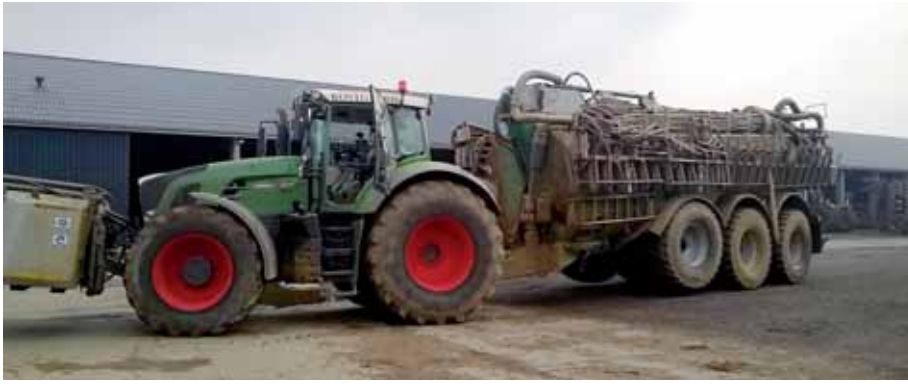
Fot. 5. Ciągnik wyposażony w zbiornik z kwasem siarkowym i wóz asenizacyjny do aplikacji zakwaszonej gnojowicy w systemie „in field”.
