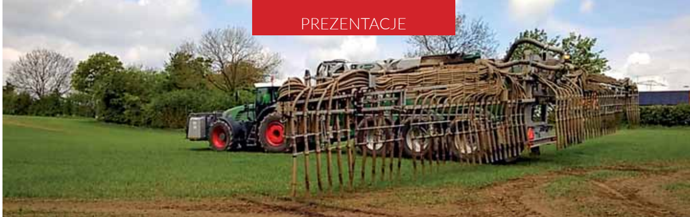
Fot. 7. Proces aplikacji zakwaszonej gnojowicy na pole w systemie „in field”
