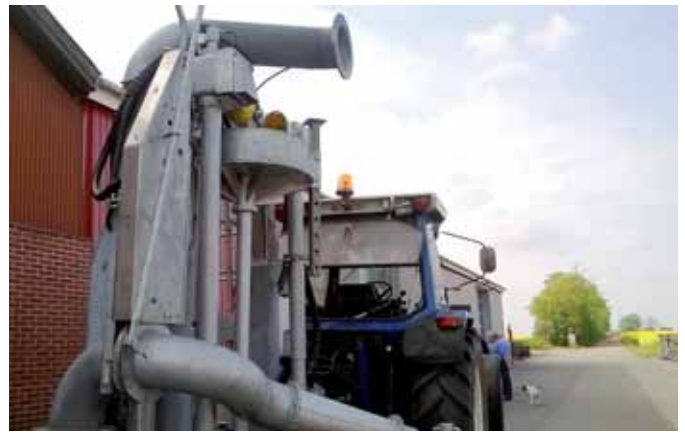
Fot. 4. System do zakwaszania gnojowicy w zbiorniku zamocowany na ciągniku.
